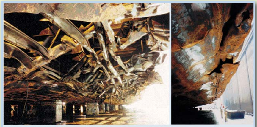
Fig. 12 - Daños sufridos en el fondo y pantoque de estribor tras la varada del buque Sea Empress cerca de Milford Haven.-- Fuente: BBC Online Network
