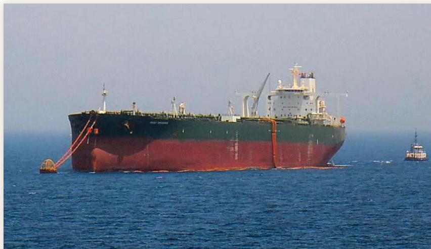
Fig. 12 – VLCC “Front Endurance” de 321.300 TPM amarrado a una monoboya de carga/descarga.- Fuente: www.aurevisser.nl
