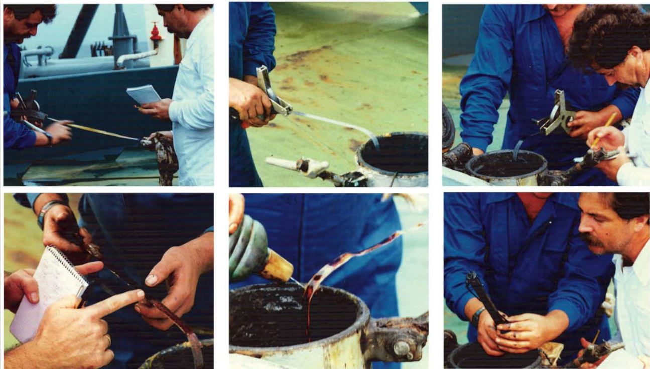
Fig. 5 – Procedimiento manual con cinta metálica para medir el contenido de los slops.- Fuente: Fotos tomadas a bordo del CBT “Corta Atalaya”.
