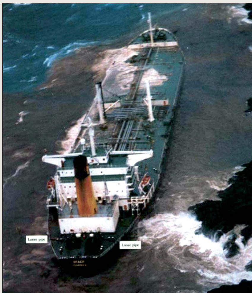
El "Braer" completamente rodeado de crudo; las notas de texto a babor y estribor de la popa se refieren a tubos sueltos. (Foto RAF Lossiemouth extraída del Informe Oficial del M.A.I.B.)
