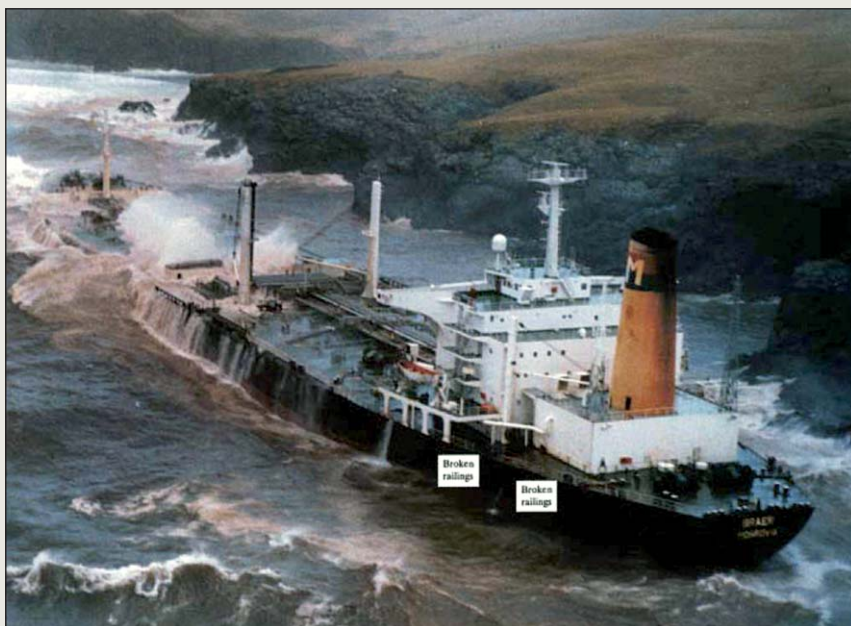
El “Braer” comenzando a perder crudo poco después de embarrancar; las notas de texto a babor del guardacalor se refieren a averías producidas por los tubos. (Foto RAF Lossiemouth extraída del Informe Oficial del M.A.I.B.)
