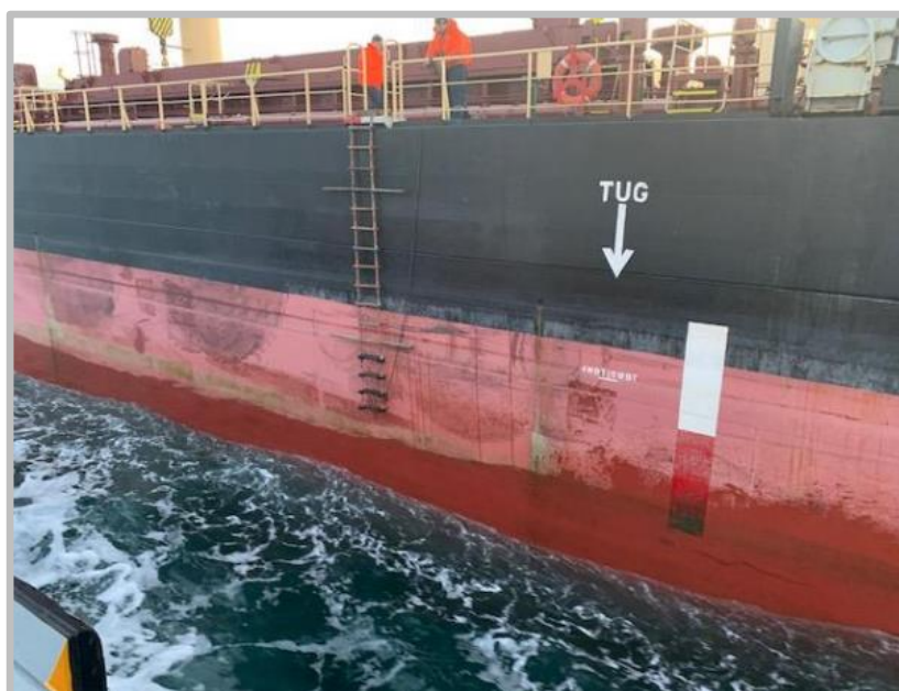
Figura 21. Marca de francobordo para práctico situada incorrectamente.
