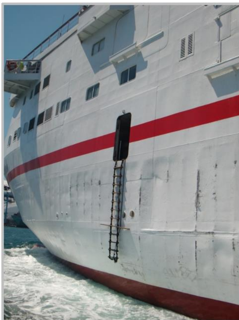
Figura 7. Escala de práctico instalada próxima a los finos de proa 2.
