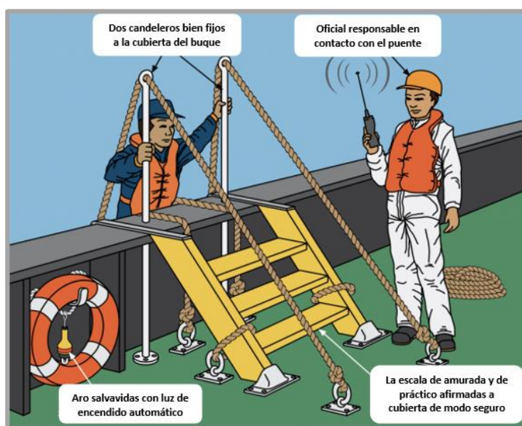
Figura 2. Requerimientos de acceso a cubierta.
