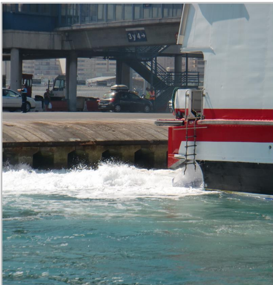
Figura 11. Acceso mediante escala de práctico no conforme por diseño del buque 2.
