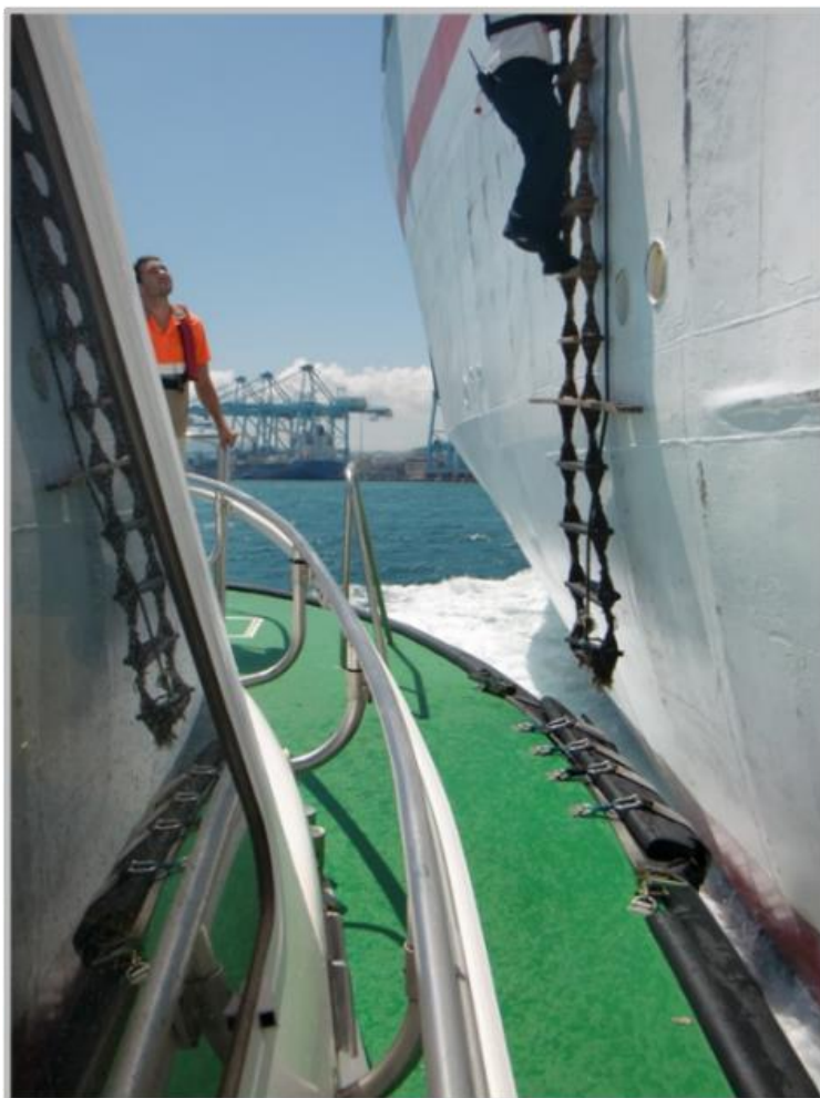
Figura 6. Escala de práctico instalada próxima a los finos de proa.
